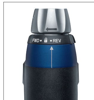
Vastupäeva pöörlemiseks keerake režiimilüliti asendisse REV.
